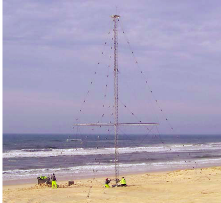
FIG. 4.39 – Antenne bicônique d'émission
